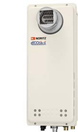
本体寸法: H619×W250×D310(mm) 【排気筒径】φ100 【排気延長】7m4曲がり以内
