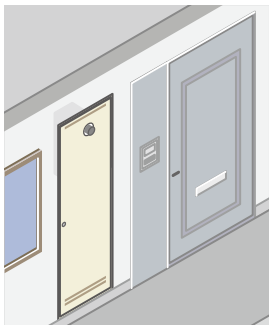
本体寸法:H619×W250×D310(mm) 【排気筒径】φ100 【排気延長】7m4曲がり以内
