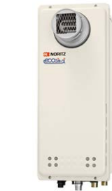
本体寸法: H619×W250×D310(mm) 【排気筒径】φ100 【排気延長】7m4曲がり以内
