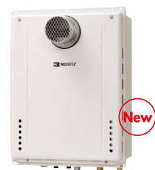
本体寸法:H600×W469×D240(mm) 【排気筒径】φ100 【排気延長】7m4曲がり以内 ・超高層設置にも対応可能 (12A13Aのみ)
