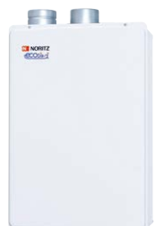
本体寸法: H690×W464×D240 (mm) 【給排気筒径】φ100 2本管 【排気延長】7m4曲がり以内
