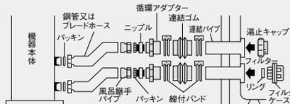
隣接設置タイプからの取り替え時のみ使用できます。入付の漏止めキャップを必ずご使用ください。ただし、浴槽の上下で温度差が生じます。フルオートタイプに使用した場合、水位がバラつくことがありますのでフルオートタイプには、おすすめてできません。
