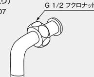
15Aネジ(プラグ)にφ12.7の銅管をロー付する場合に使用します。
